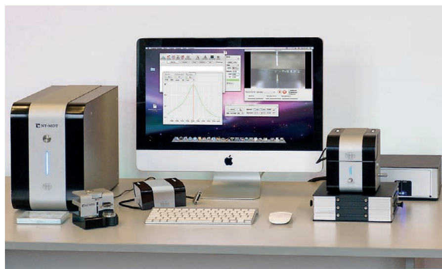
Рис. 6. Сканирующий зондовый микроскоп для исследования пластин, диаметром до 200 мм – «ВЕГА» с системой термостабилизации и акустозащиты (а) с установленными на подвижный стол пластинами диаметром 100 мм. Точность поддержания температуры 5 \cdot 10^{-3} °С, подавление шумов – 30 ДБ
