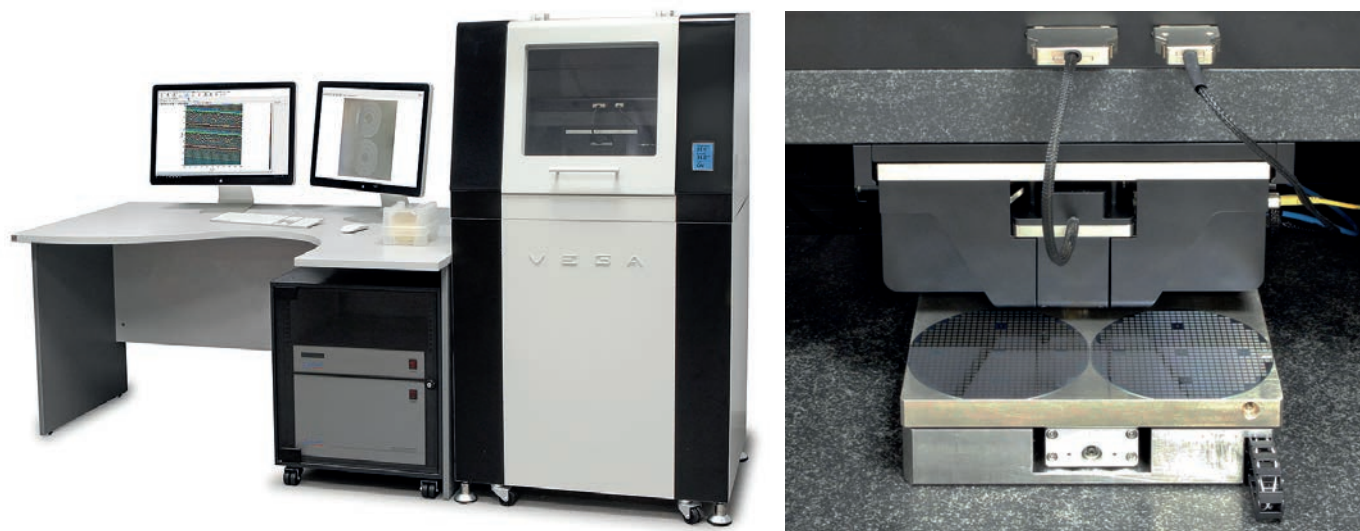
Рис. 6. Сканирующий зондовый микроскоп для исследования пластин, диаметром до 200 мм – «ВЕГА» с системой термостабилизации и акустозащиты (а) с установленными на подвижный стол пластинами диаметром 100 мм. Точность поддержания температуры 5 \cdot 10^{-3} °С, подавление шумов – 30 ДБ
